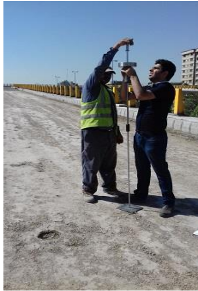
نحوه تست و کالیبراسیون دستگاه نفوذگر دستی
